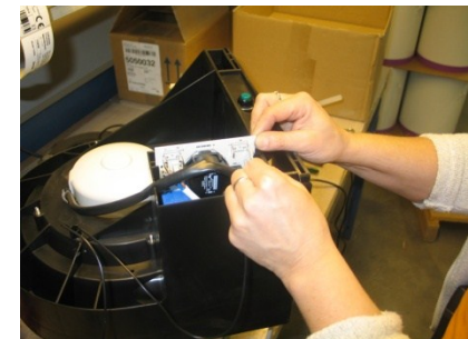
Kytke uudet moottorijohdot paikalleen. Tiivistä johtojen läpivienti moottorikoppaan esim. kuumaliimalla.
