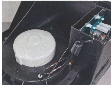
8. Liitä moottorin johdot ja asenna kortti paikalleen.
